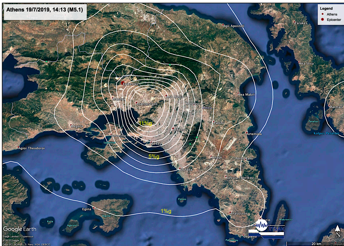
Σχήμα 3. Χάρτης αισθητότητας της σεισμικής δόνησης (Shakemap) όπως προέκυψε με τη χρήση των σταθμών επιταχυνσιογράφων εγκατεστημένων από το ΙΤΣΑΚ και το Γεωδυναμικό Ινστιτούτο του ΕΑΑ στην ευρύτερη επικεντρική περιοχή του σεισμού της 19/7/2019, 14:13 ώρα Ελλάδας.
