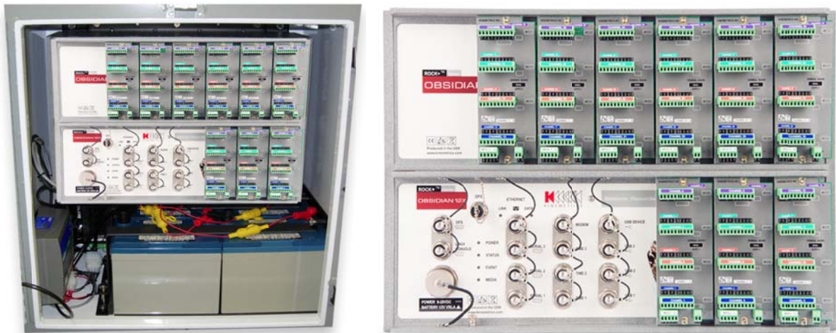
Σχήμα 1: Κονσόλα κεντρικής καταγραφικής μονάδας, παρόμοιος τύπος με την οποία βρίσκεται στο έργο και μπαταρίες οι οποίες λειτουργούν κατά την διακοπή ηλεκτρικού ρεύματος η οποίες επαναφορτίζουν με την αποκατάσταση της ρευματοδότησης (αριστερά). Υποδοχείς καναλιών (δεξιά). [2]
