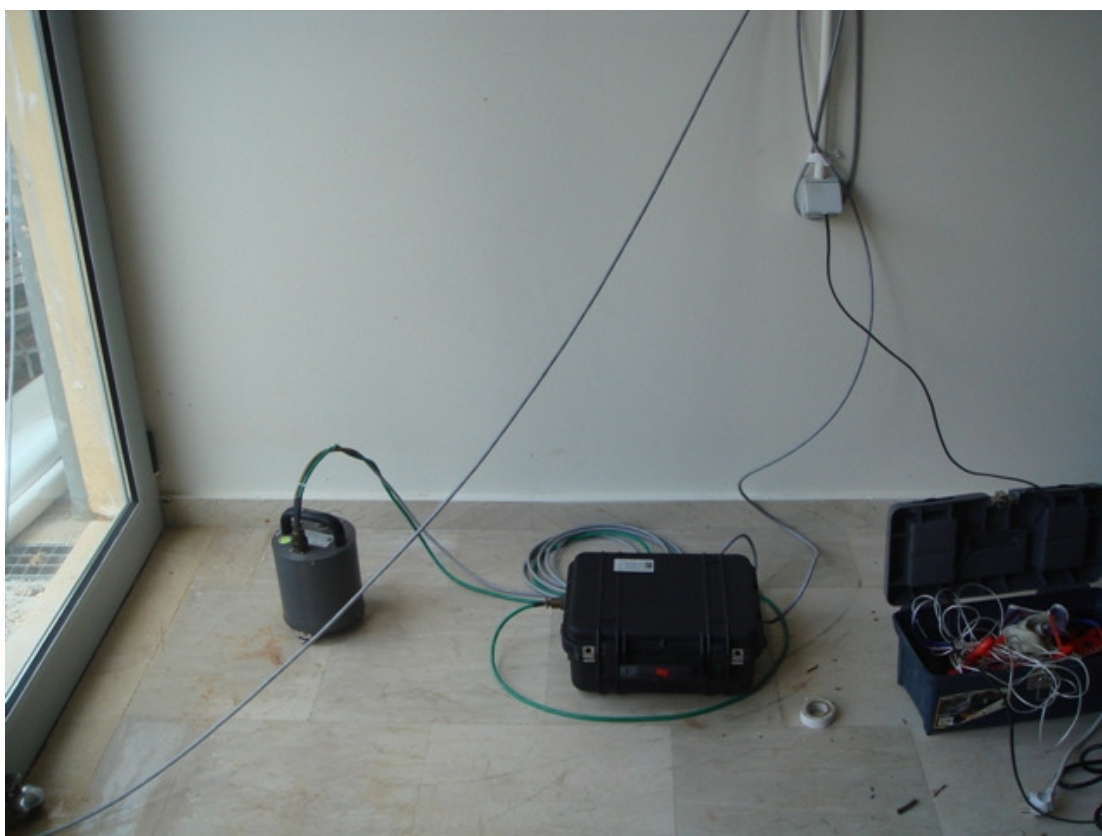
Εικόνα 2. Εγκατάσταση φορητού σεισμογράφου
