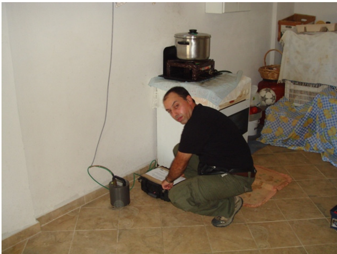
Εικόνα 1. Εγκατάσταση φορητού σεισμογράφου
