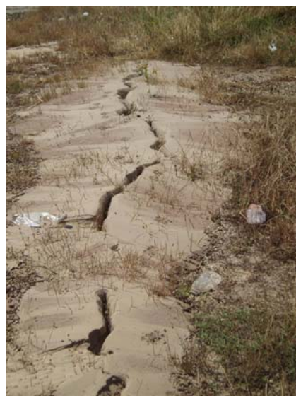
Φωτ. 2.6: Κάτω Αχαΐα – ανατολικά: Εδαφικές ρωγμές χωρίς (αριστερά) ή με ανάδυση (αριστερά) αμμώδους υλικού. Οριζόντια μετατόπιση από 4 έως 8cm και κατακόρυφη μετατόπιση από 3 έως 6cm
