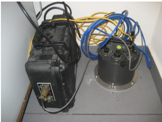
Εικόνα 1. Επιταχυνσιογράφος και τροφοδοτικό (αριστερά) από την εγκατάσταση στο Δημαρχείο της Κω (KOS2). Η εξωτερική εικόνα από την εγκατάσταση φαίνεται δεξιά.
